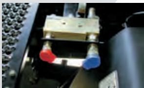
Гидравлические соединения разбрасывателей с электромагнитным включением
