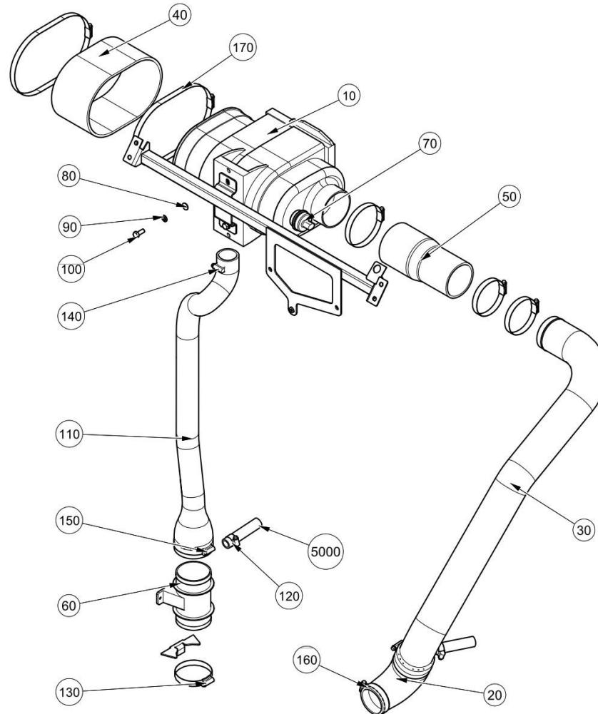
**Luftfilter Installation Stufe 3A ( )**
