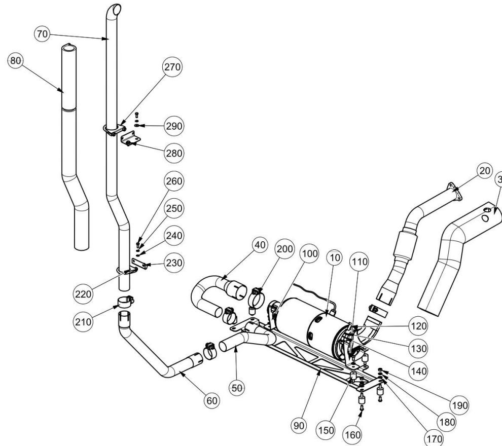
**Abgassystem Stufe 3B ( )**
