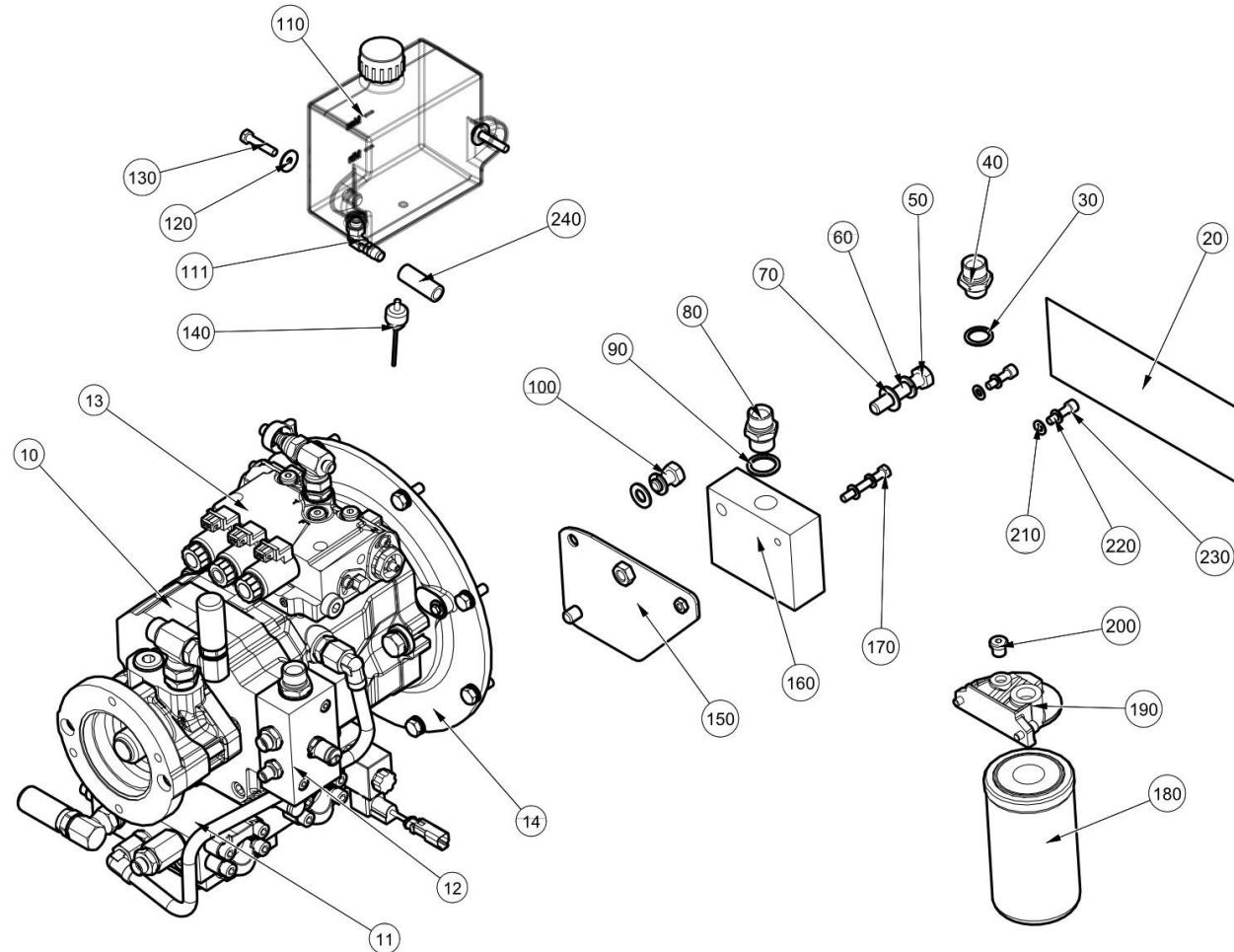
**Antriebspumpe, Filter & Ausgleichbehälter ( )**
