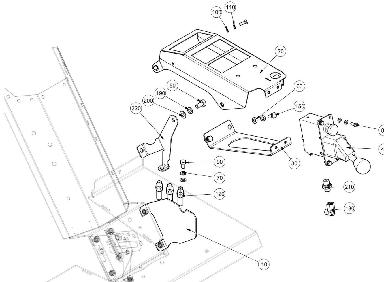
**Hydraulische Handbremse (37140-1)**
