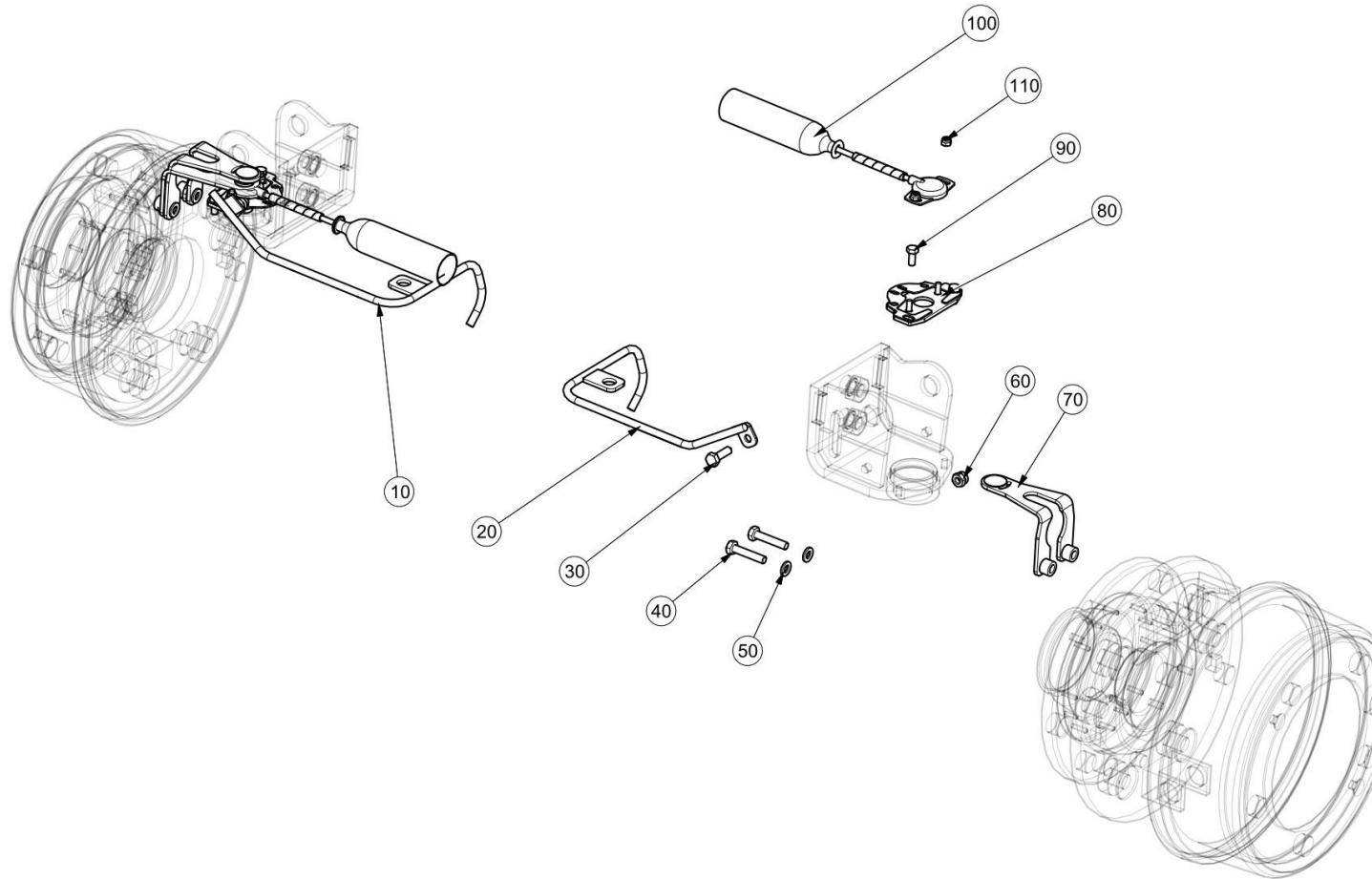
**Vorderachse 4WS Sensoren ( )**
