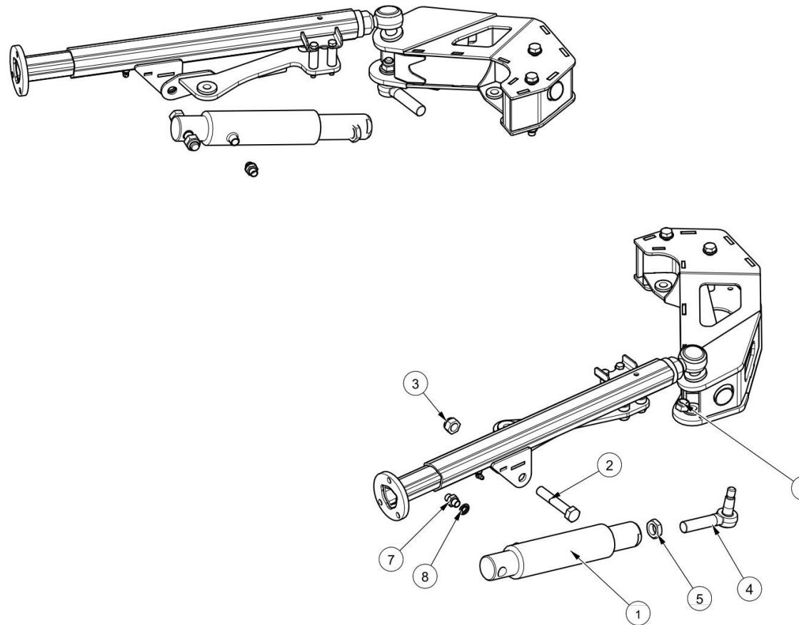
**Hebezylinder, seitlicher Bürstenarm (37052-51)**
