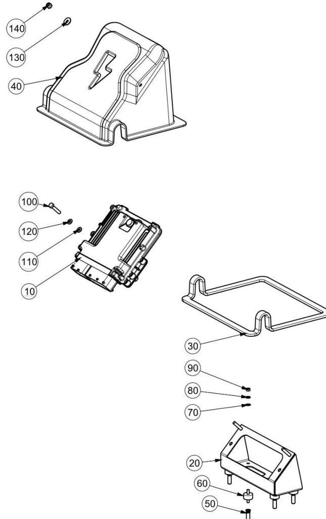
**Motor ECU Steuergerät Stufe 3B ( )**
